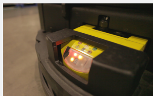
Les chariots automatisés évitent les collisions grâce à leur scanner de sécurité qui détecte les objets.
