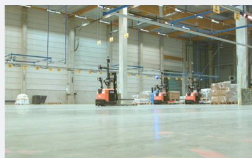
Les chariots autoguidés (AGV) se déplacent en marche arrière, ce qui augmente non seulement la sécurité mais également la productivité.
