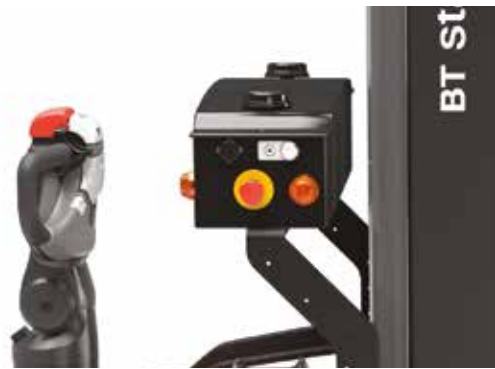
Boutons d'arrêt d'urgence faciles d'accès pour le personnel
