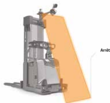
Détection d'obstacles au-dessus du niveau du sol
