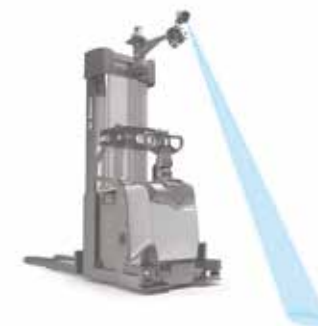
Feu bleu à LED pour alerter les piétons et les caristes si le chariot sort de zones non visibles
