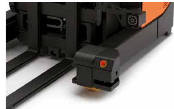
Boutons d'arrêt d'urgence sur les bras-support pour encore plus de sécurité
