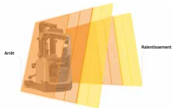
Détection d'obstacles latéraux qui entrent sur la trajectoire du chariot par le côté
